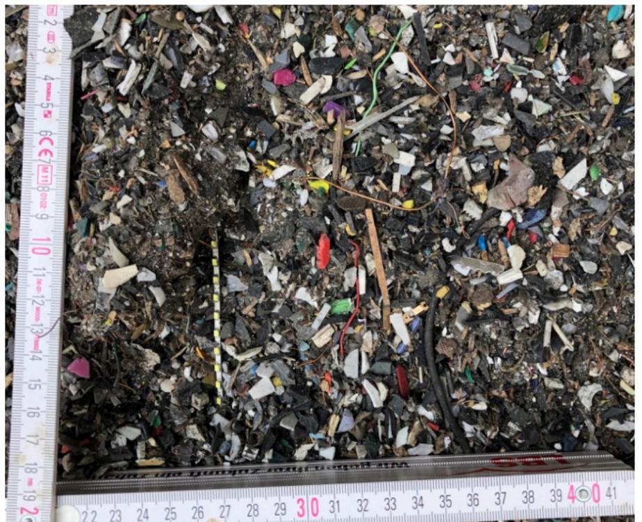
Wir verarbeiten verschiedene Kunststoff-Metall-Mischungen aus der Aufbereitung von E-Schrott.
